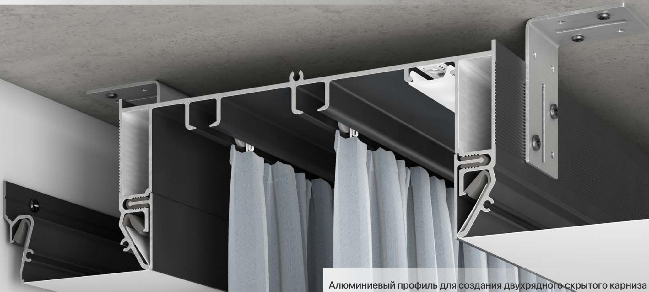
Алюминиевый профиль для создания двухрядного скрытого карниза с подсветкой и креплением натяжного потолка в одной плоскости
